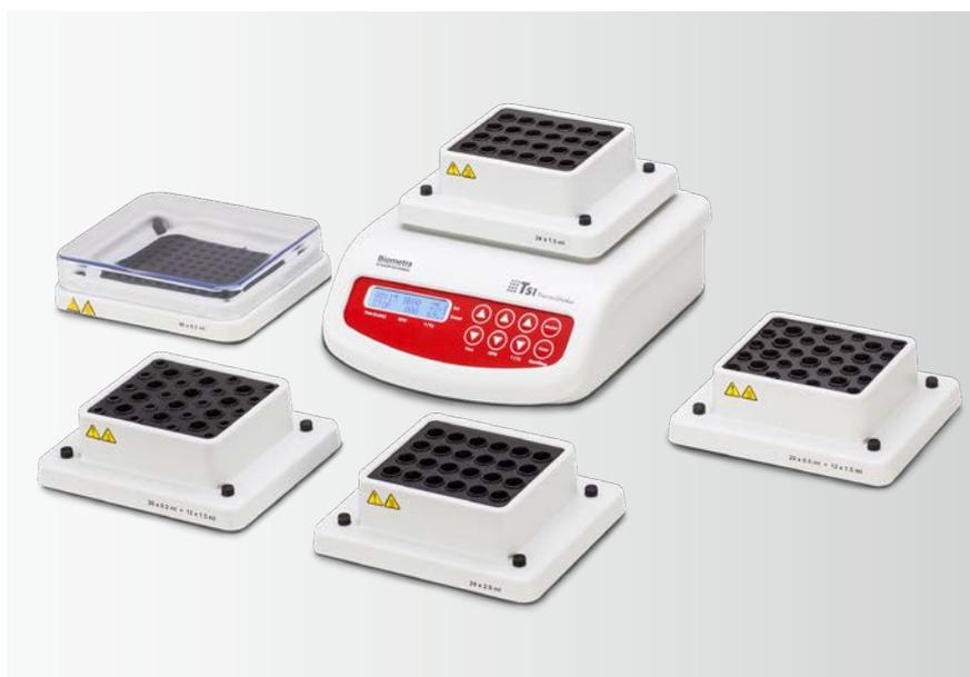
Der Biometra TS1 ThermoShaker ist ein Thermomixer mit variabler Mischfrequenz und variabler Inkubationstemperatur für Reaktionsgefäße bis 2 ml. Die Kombination der Inkubationsphase mit dem Mischprozess führt zu einer Verkürzung der Reaktionsprozesszeit, reduziert den Aufwand für den Anwender und erhöht die Effizienz für viele Prozeduren (z.B. Transformation von Bakterienzellen).
